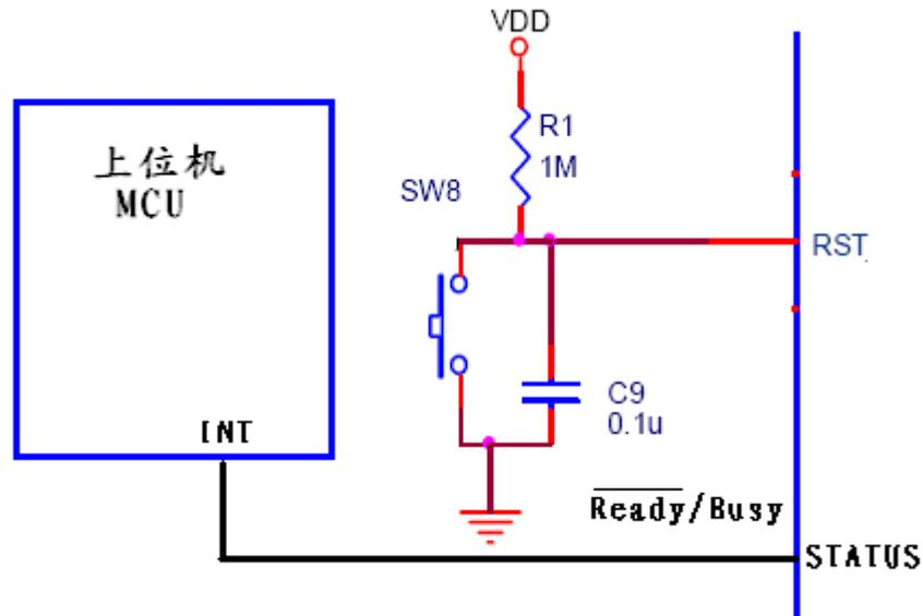
备注： $\overline{\text{Ready/Busy}}$  此 STATUS 引脚信号为低电平时说明芯片正在等待接收数据。在系统设计时可以将此引脚接在MCU的中断输入源上，产生一个下降沿中断请求发送数据，以示上位机MCU可以向语音合成芯片发送数据。
