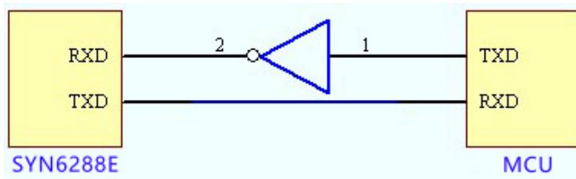
备注: 上位机发送数据给 SYN6288E 时, 中间须加有反向器, 并须遵循《串口通信反向电路》一节中的说明。
