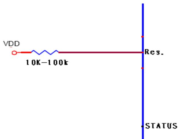
注：也可以考虑和复位引脚 RST 的接法类同，配置一个较小的电容（其它组电源配置较大的电容），使得 SYN6288E 各组电源供电前，Res. 引脚能置为高电平！这样可以有效防止外部电源的突发性干扰。
