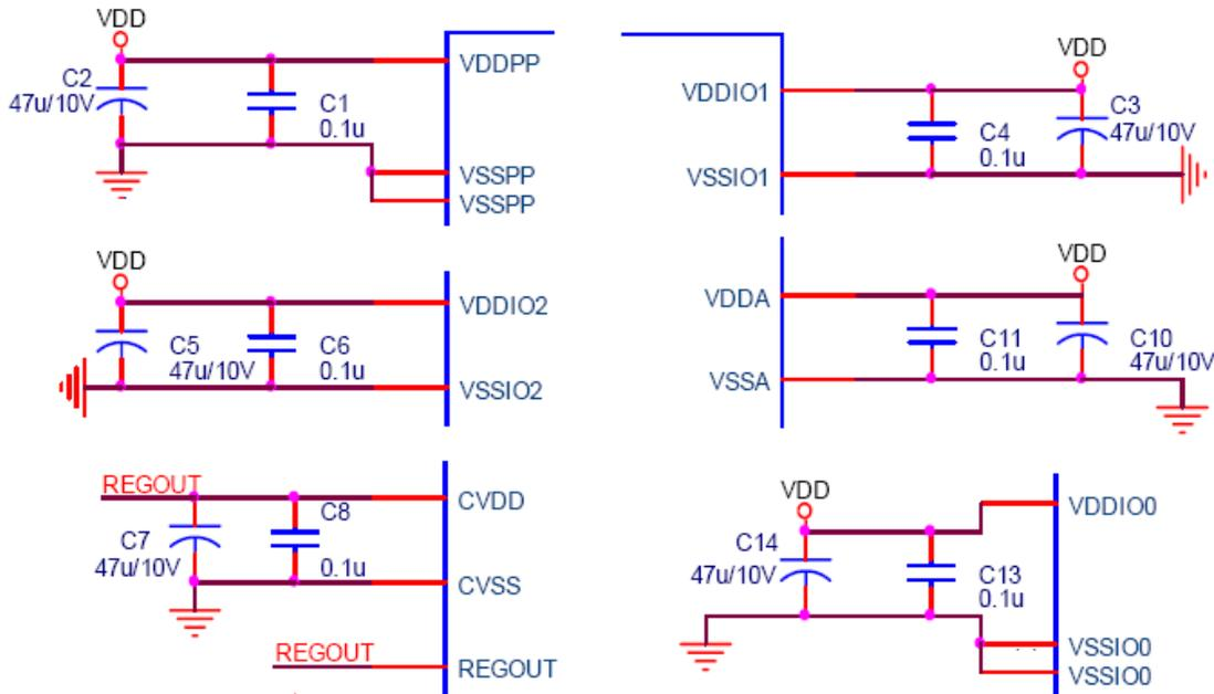
**备注1:** SYN6288E共有6组外接电源，每组电源均使用一个47uF和一个0.1uF的电容；如果用户想节省成本，用户可以在每组电源上均使用0.1uF的电容，并对VDDPP、和VDDA两组电源，各加上一47uF的电容。
